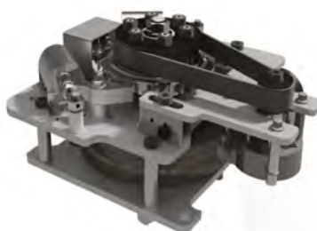
Drehkreuzmechanismus – hochwertige Bremse mit kurzer Ansprechzeit.
